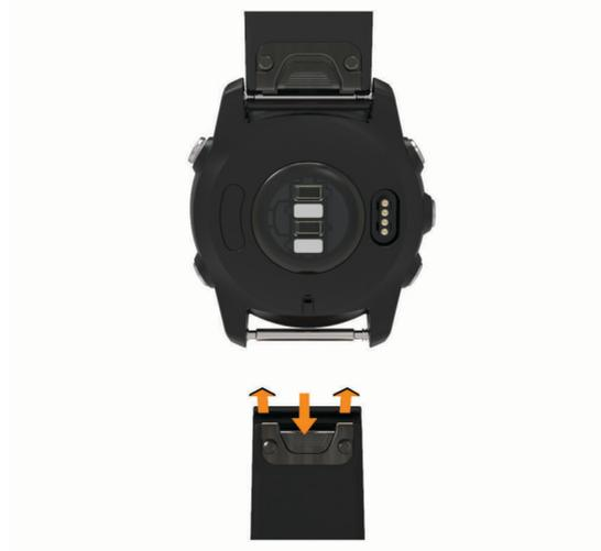
**ПРИМЕЧАНИЕ.** убедитесь, что ремешок закреплен надежно. Фиксатор должен защелкнуться на штырьке часов.
