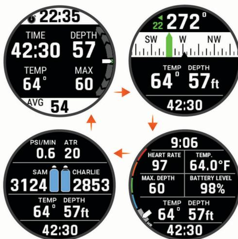
**Секундомер для дайвинга:** отображает секундомер времени на максимальной глубине; текущую, максимальную и среднюю глубину, а также скорость подъема или погружения ([Использование секундомера датчика погружения, стр. 30](#)).
