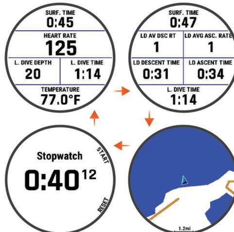
**Экран интервала между погружениями 1:** отображение текущего интервала между погружениями, частоты пульса и информации о последнем погружении. Можно редактировать компоновку экрана и поля данных, отображающиеся на ней.
