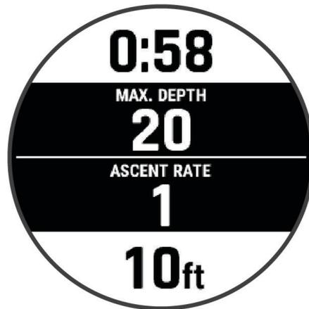
**Экран данных погружения:** отображение информации о текущем погружении, включая прошедшее время, текущую и максимальную глубину, а также скорость подъема или погружения. Можно редактировать компоновку экрана и поля данных (*Настройка экранов данных*, стр. 131).
