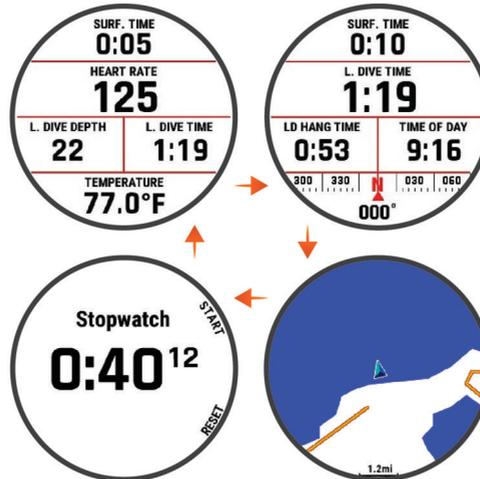
**Экран интервала между погружениями 1:** отображение текущего интервала между погружениями, частоты пульса и информации о последнем погружении. Можно редактировать компоновку экрана и отображающиеся на нем поля данных.
